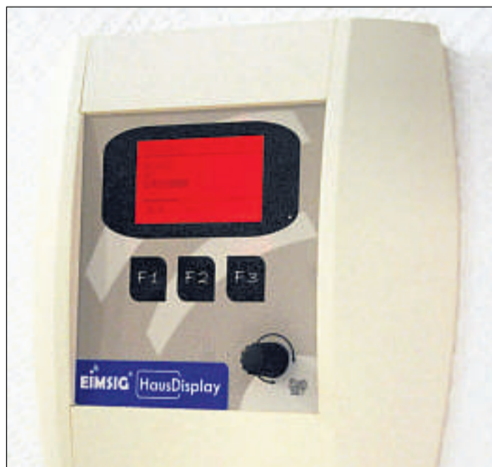
Die Zentrale zeigt an: Bei offenem Fenster leuchtet die Farbe rot auf und bei geschlossenen Fenstern grün. Sind die Fenster gekippt, erscheint die Farbe gelb. Besonderheit: Auch in gekipptem Zustand können die Fenster gesichert werden.
